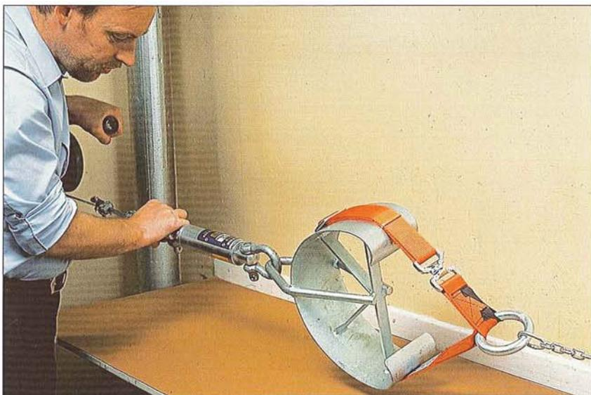
Das PIAB Dynamometer mit eingebautem Ferngeber überwacht die erlaubte Höchstbelastung. Gewichtsmessungen und das Einstellen der Schaltpunkte erfolgen auf einem Fernanzeigerät im Führerhaus.
