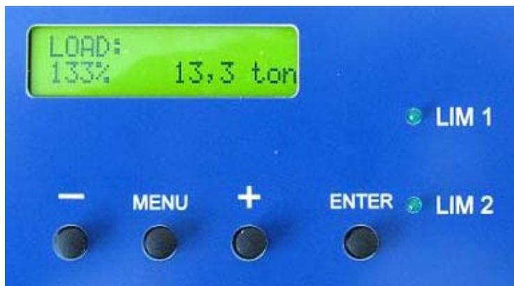
Die Programmierung von Kapazität (Summe von Nutz- und Totlast), Schaltgrenzen, usw. wird mit den Tasten in nachstehender Reihenfolge gemacht:
